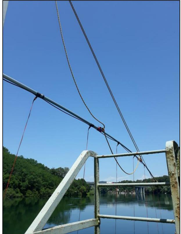
Fig. 11 – Sostegno del cavo geoelettrico e degli elettrodi passivi a boe galleggianti nella parte di valle della diga (a sinistra) e fissaggio del cavo geoelettrico, con relativi elettrodi appesi, ad un'asta telescopica nella parte di monte
