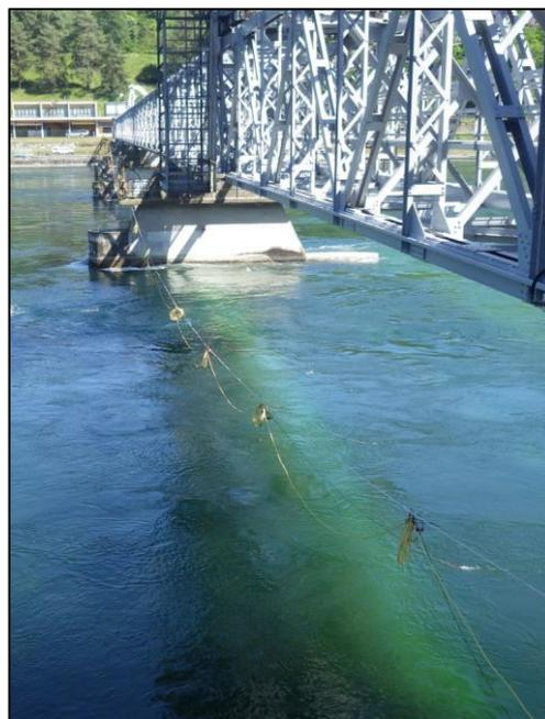
*Fig. 10 – Operazioni di fissaggio del cavo geoelettrico al cavo guida (a sinistra) e panoramica dello stendimento con i cavi unipolari posti a contatto con il pelo libero dell'acqua*
