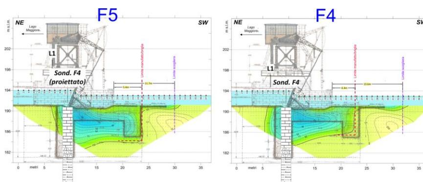
Fig. 14 – Sezioni geoelettriche F5 e F4, eseguite in direzione perpendicolare alla traversa all'interno della Campata 1
