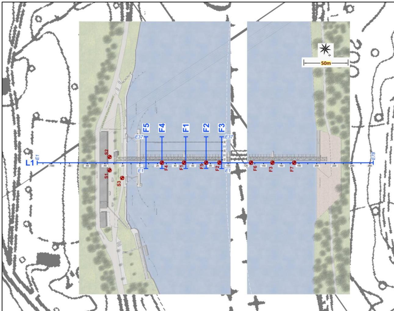
Fig. 2 - Estratto planimetrico con l'ubicazione delle indagini geoelettriche eseguite (in blu) e dei sondaggi geognostici (in rosso) nella zona d'indagine
