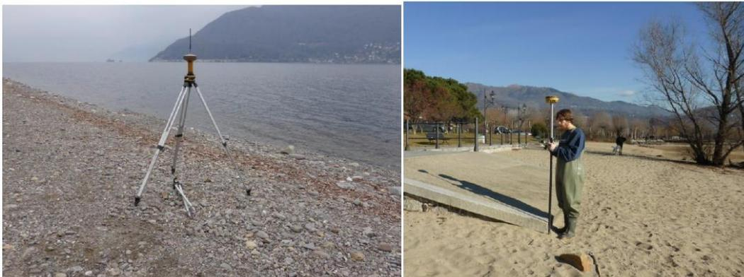
Figura 93 - Esempi di rilievo GPS in RTK: a sinistra il rilievo è stato condotto con il sistema base-rover (spiaggia di Maccagno); a destra è stato effettuato il collegamento alla rete di stazioni fisse NatGeo (Baveno).
