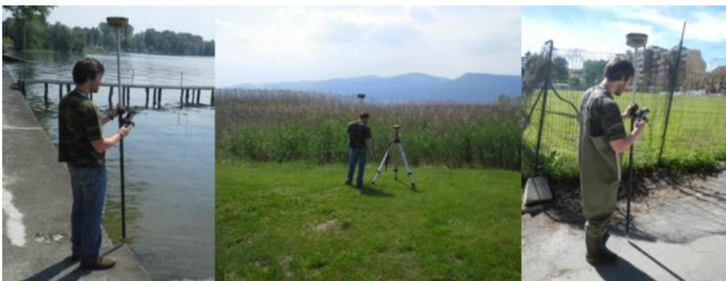
Figura 11 – Settaggio della strumentazione (base-rover) e rilievo dei capisaldi di riferimento.
