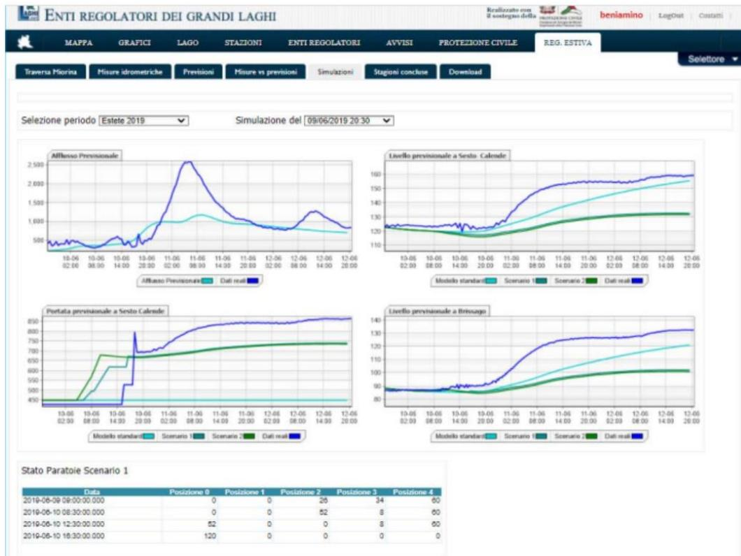
Figura 70 - Modello previsionale: confronto tra l'effettivo andamento delle grandezze idrometriche e le previsioni elaborate dal modello di calcolo rispetto a determinate serie di manovre sullo sbarramento.
