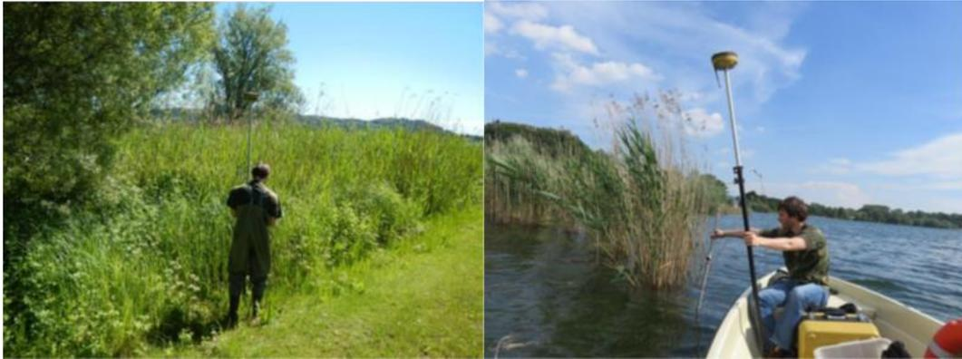
Figura 12 - Rilievo dei punti GPS a piedi e da barca sul perimetro del canneto.
