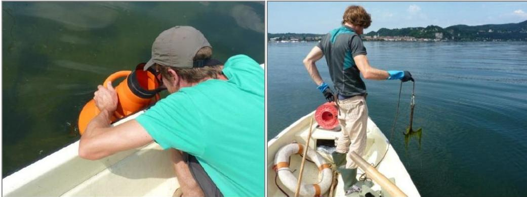
Figura 19 – Esempi di impiego del batiscopio e rampino.
