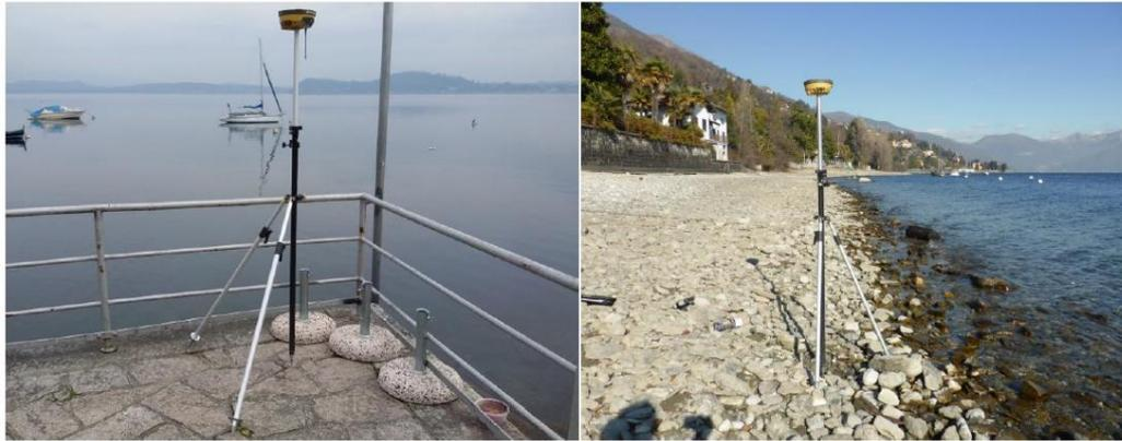
Figura 94 -Esempi di rilievo di un caposaldo IGM (a sinistra, Belgirate) e del pelo libero dell'acqua (a destra, Oggebbio).
